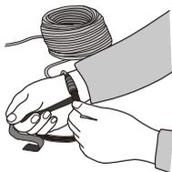
端子の接続部分を防水ボックスなどに入れない場合は完全に隠すように巻きつけます。
