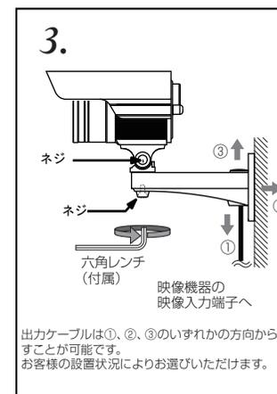
出力ケーブルは①、②、③のいずれかの方向から出すことができます。お客様の設置状況によりお選びいただけます。
