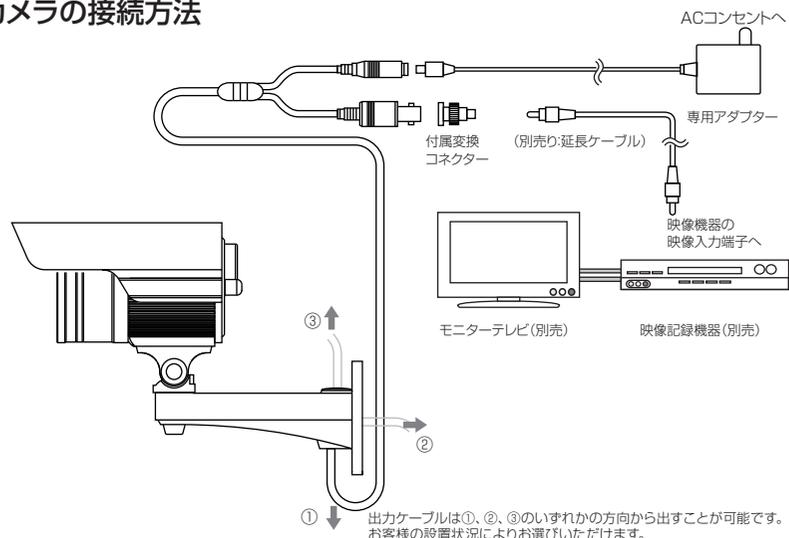
① ↓ 出力ケーブルは①、②、③のいずれかの方向から出すことができます。お客様の設置状況によりお選びいただけます。
